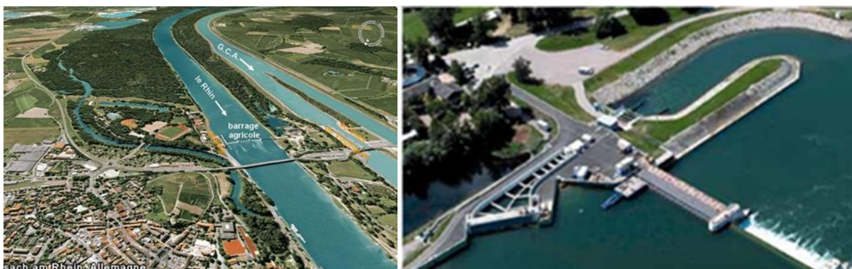
Figuur 29: Stuw voor peilbeheer en microcentrale in Breisach
