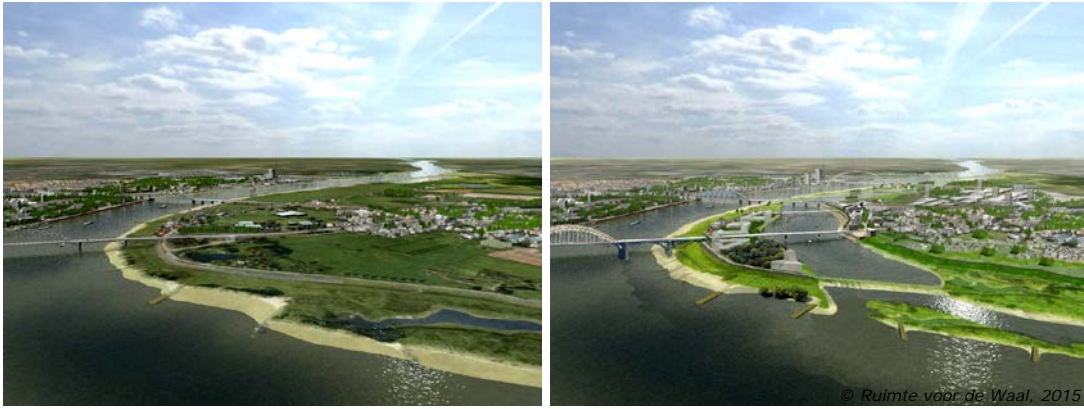
Beispiel für die flusserweiternde Maßnahme bei Lent/Nijmegen, Niederlande. Deichrückverlegung Lent, links: heutige Situation, rechts: zukünftige Situation (Programm „Raum für den Fluss“, Projekt „Raum für den Waal“ http://www.ruimtevoordewaal.nl )
