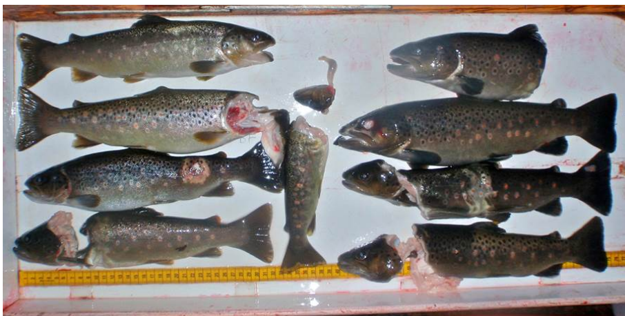
Abb. 3: Schadensbilder an Salmoniden. Funktionskontrolle der Fischabstiegsanlage am Kraftwerk Kostheim/Mainmündung; Dezember 2011. Quelle: BFS
